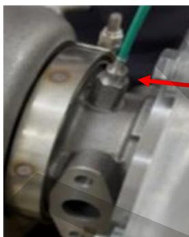
Serrare il sensore di velocità a 15,0 – 17,0 Nm.
