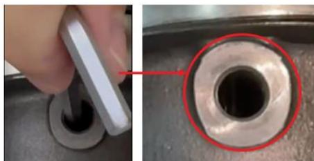
Le immagini sopra mostrano il foro del distanziatore del cuscinetto allineato con il foro dell'alloggiamento centrale.
